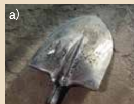
写真7: 焼き戻しをしない製品はハンマーで叩くと粉々に割れてしまう。 a) 焼き戻しを施さない製品 b) c) タオルで包みハンマーで叩き粉々に割れてしまった状態
