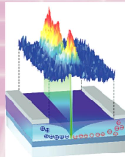
だけで作ることができるのである。有機半導体として、発光性の材料であるテトラセンを用いると、このPN接合からの発光がおこすことができる。しかも、このPN接合はゲート電場によってできているため、発光位置や強度がゲート電圧によって制御できるという特徴を持つ。
