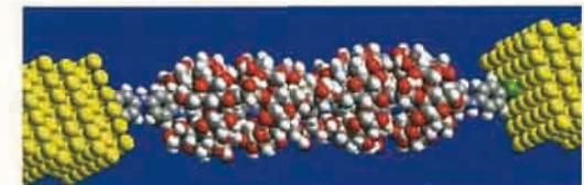
図2. シクロデクストリンで被覆した高分子をイオウ原子経由で金電極に接続したナノスケール配線の例。
