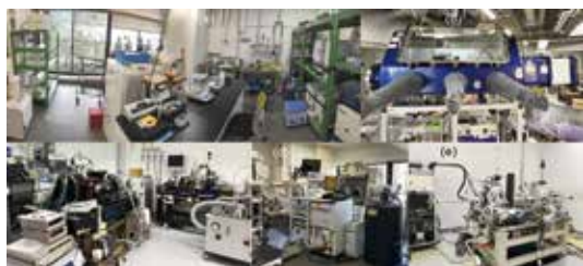
図1: 使用する主な実験装置 (a)結晶成長炉、(b)2次元材料の劈開と転写を行うグローブボックス、(c)低温プローブ、(d)輸送特性評価用PPMS、(e)3次元磁場の印加と300mKでの測定が可能な超高真空極低温STM (各種蒸着器とPLDが付属)
