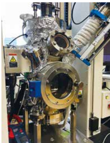
応力負荷条件下で水素昇温脱離分析を行うための新規開発装置
