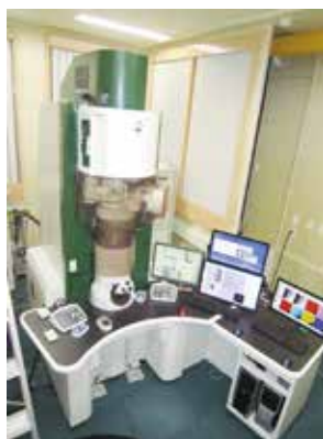
原子炉構造材料など中性子照射によって放射化した材料のナノ組織観察を行う分析装置（左：収差補正透過電子顕微鏡、右：レーザー補助3次元アトムプローブ）
