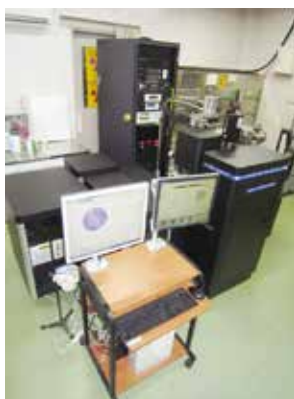
原子炉構造材料など中性子照射によって放射化した材料のナノ組織観察を行う分析装置（左：収差補正透過電子顕微鏡、右：レーザー補助3次元アトムプローブ）
