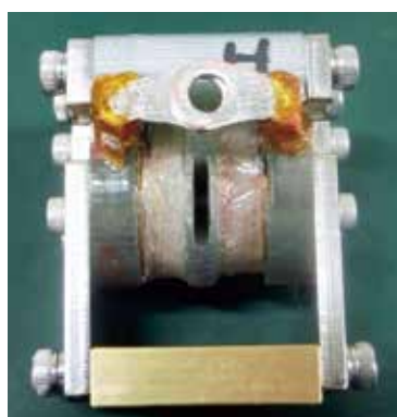
図1:X線自由電子レーザー回折装置用のスプリット型パルス強磁場磁石。体積約15ccと超小型だが40テスラを超える超強磁場を発生可能で、これを用いる事で、これまで不可能だった強磁場中における高温超伝導体の電荷密度波による微弱な回折信号の測定に成功した。
