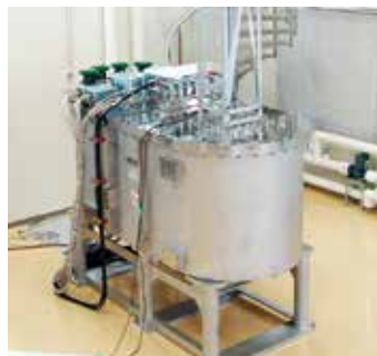
高温超伝導体を用いて、超伝導だけで25Tの強磁場を発生する無冷媒超伝導磁石。52mmの室温空間に無冷媒では世界最高の25.1Tの磁場を発生する。
