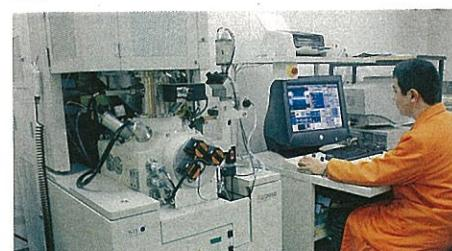
集束イオンビームを走査しながら照射することにより材料の精密加工を行う。放射化したTEM試料、3D-APFIM試料(左下写真)等の加工が可能である。また、ガリウムイオンによる材料表面の損傷は、同室に設置されている低エネルギーイオンソース搭載のジェントル・ミル(右下写真)で除去できる。
