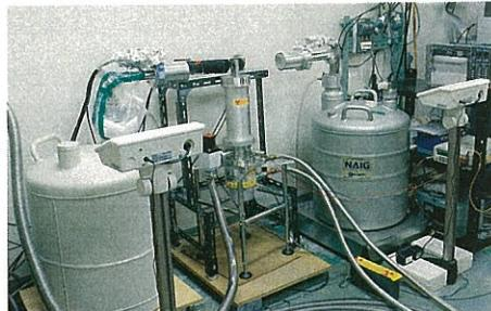
陽電子消滅同時計数ドッplerー広がり測定は、2台の半導体検出器によって、2本の陽電子・電子対消滅γ線のエネルギーの精密測定を行い、照射欠陥周囲および超微小析出物の化学元素分析を行う。陽電子寿命測定は、空孔や空孔集合体の寸法や数密度の評価を行う。
