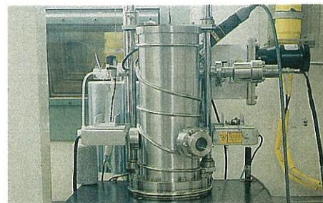
真空および不活性ガス雰囲気で照射後疲労特性を評価する。荷重、軸変位および径ひずみによる制御が可能で、任意の加振波形を選択できる。本装置ではレーザー変位計による非接触のひずみ計測方式を採用し、砂時計型試験片の最小直径変化を $\pm 1\mu\text{m}$ の分解能で計測することが可能である。下図は、JLF-1の疲労特性に及ぼす中性子照射の効果を示す。
