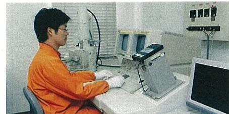
2次電子像および後方散乱電子像観察のほかに、特性X線元素分析(EDS)也可能である。
