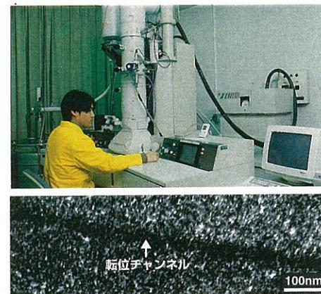
加速電圧200kV、400kVの2台が設置され、放射化した試料の内部組織観察を行なう。高分解能観察、EDS分析、高温引張その場観察等も可能である。図は低温で中性子照射されたバナジウム合金の損傷組織である。照射欠陥集合体が転位運動によって掃過された転位チャンネルが観察される。
