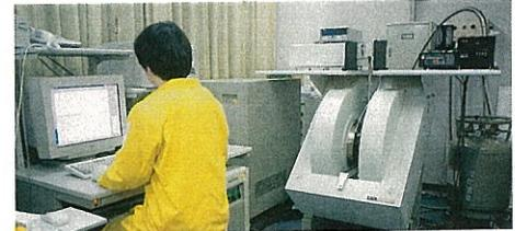
半導体やガラスなどの常磁性欠陥を敏感に検出・同定できる。液体ヘリウム温度での測定が可能である。
