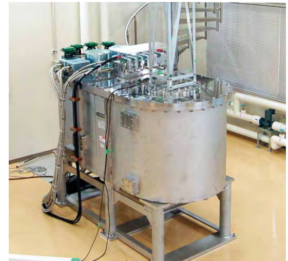
強磁場センターで開発された 25T無冷媒高温超伝導マグネット
