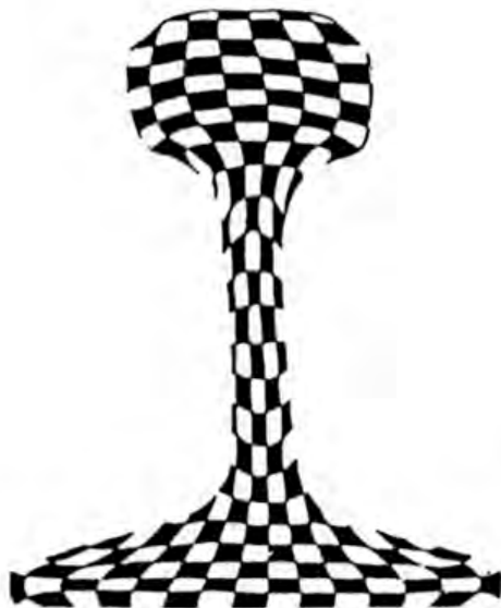
図 20-11 レール圧延の際の変形模擬実験例
