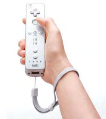
任天堂 Wiiリモコン (3軸加速度センサ内蔵)
