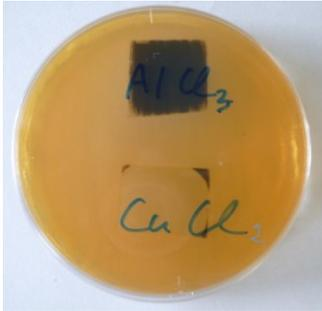
図1 塩化第2銅水溶液および塩化アルミニウム水溶液に浸漬させた透明プラスチックを用いた場合の新法による抗菌性試験結果
