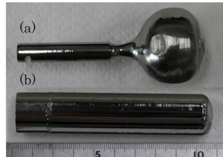
図 1 評価した Ge 結晶の写真
