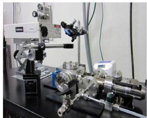
図 1. 自作したレーザー窒化装置
