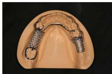
図1 歯科铸造法により試作したCo-33Cr-5Mo-0.3N合金の義歯床
