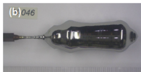
図 1 \text{B}_2\text{O}_3 を部分的に覆った Ge 融液からの (a) 成長中の写真、(b)成長後の結晶の写真
