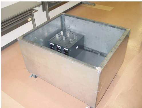
図 1 キャスター付コンデンサーバンク。奥行きを 820 mm 弱としているので、標準的な実験室のドアを通過できる。
