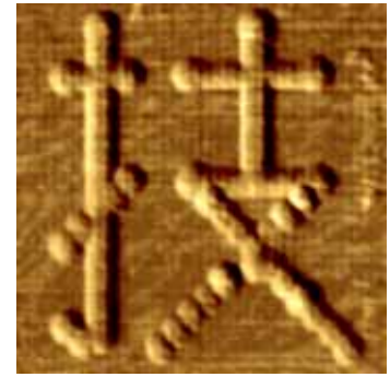
図 11 AFM の陽極酸化法により描かれた文字
