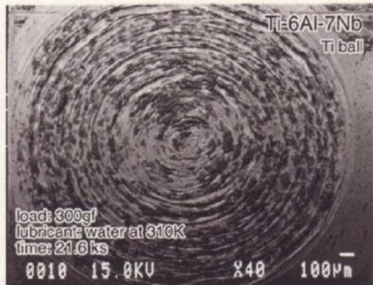
Fig. 3 純水中で試験した Ti-6Al-7Nb の摩耗表面の反射電子像。荷重 3 N, 測定時間 21.6 ks
