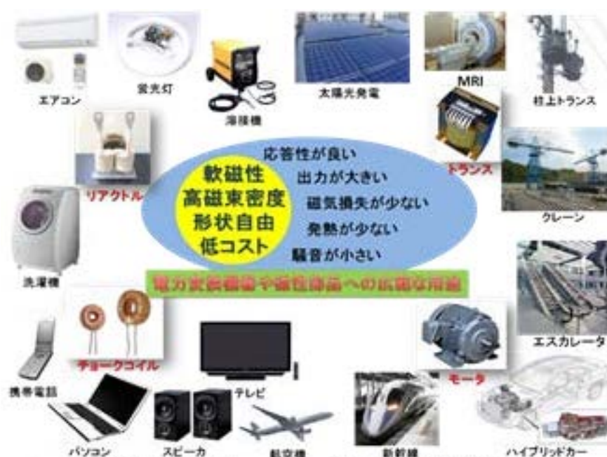
Fig.1 軟磁性材料の用途 (我々の日常生活を支えるほとんどの電化製品に使用される)
