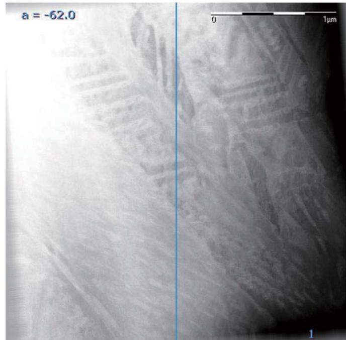
図 7 Ti-12V-2Al 合金のマルテンサイト相が相分離した後の組織 (STEM-HAADF 像)
