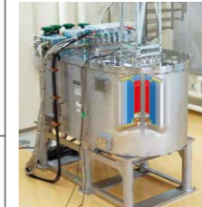
高温超伝導体を用いて、超伝導だけで25Tの強磁場を発生する無冷媒超伝導磁石。52mmの室温空間に無冷媒では世界最高の25.1Tの磁場を発生する。
