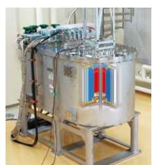
高温超伝導体を用いて、超伝導だけで25Tの強磁場を発生する無冷媒超伝導磁石。52mmの室温空間に無冷媒では世界最高の25.1Tの磁場を発生する。
