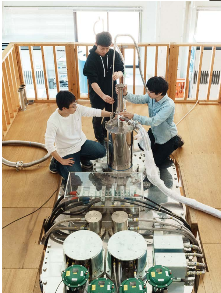
高温超伝導体を用いて、超伝導だけで25Tの強磁場を発生する無冷媒超伝導磁石。52mmの室温空間に無冷媒では世界最高の25.1Tの磁場を発生する。
