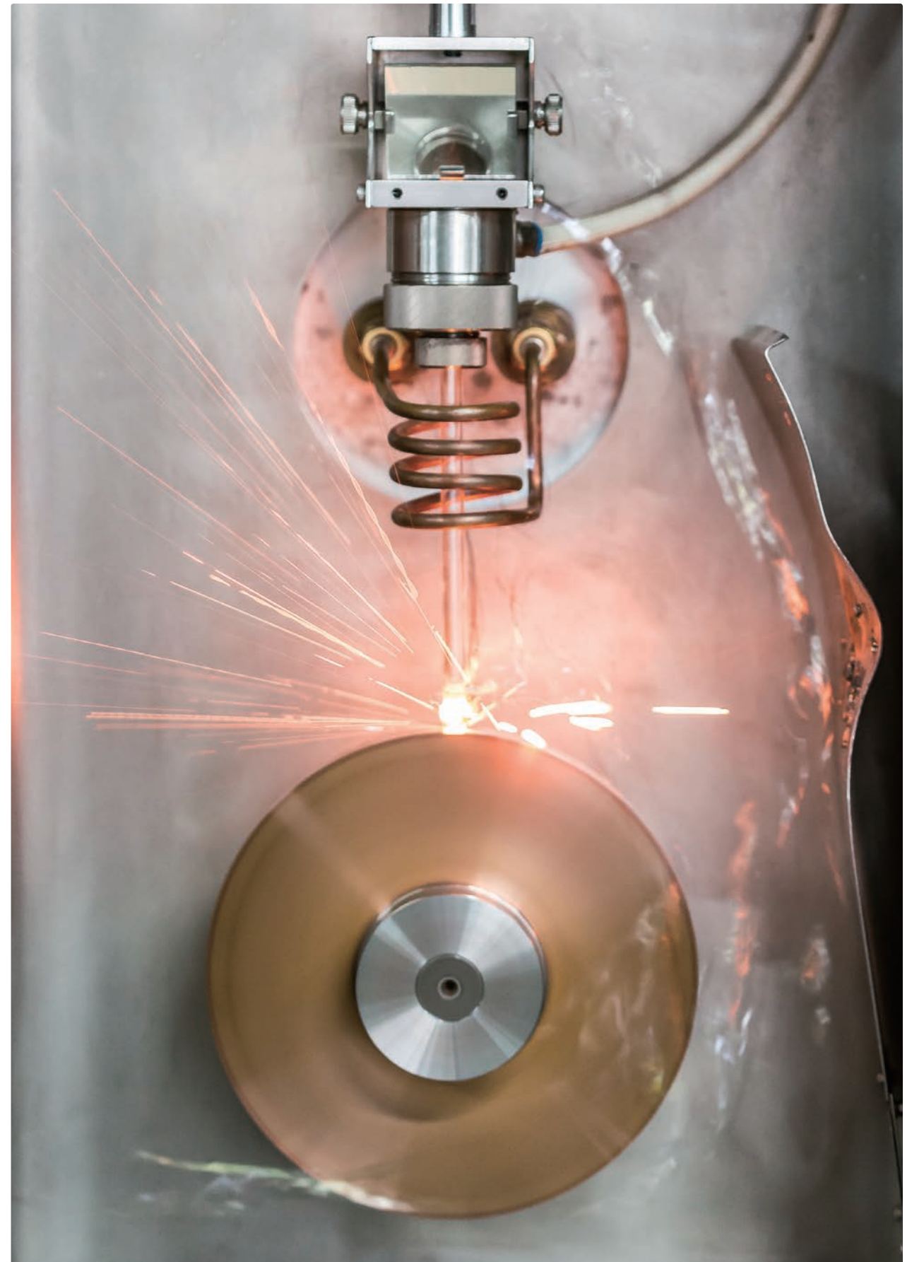
急激に冷やすことによって作られる金属ガラスリボン
