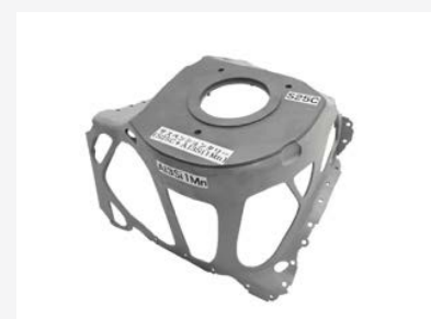
図2: 本研究を基に作製した自動車部材(サスペンションタワー)。トポロジー最適化を用いて設計されたもので、積層造形技術の特徴を最大限に活かした構造となっている。
