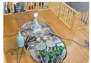
無冷媒超伝導マグネットでは世界最高磁場25Tを発生できる25T-CSM。磁場に影響が出ないよう、作業台が木枠で作られている。
