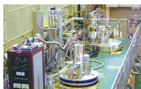
写真奥: 30年間現役のハイブリットマグネット(31T-HM) 手前: 世界的にもユニークな無冷媒ハイブリットマグネット(28T-CHM)
