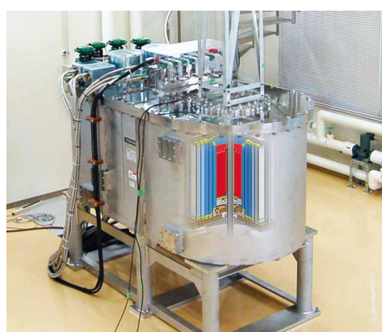
図1: 25T無冷媒超伝導マグネット
