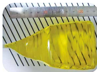
図1: 新規ランガサイト型単結晶外観
