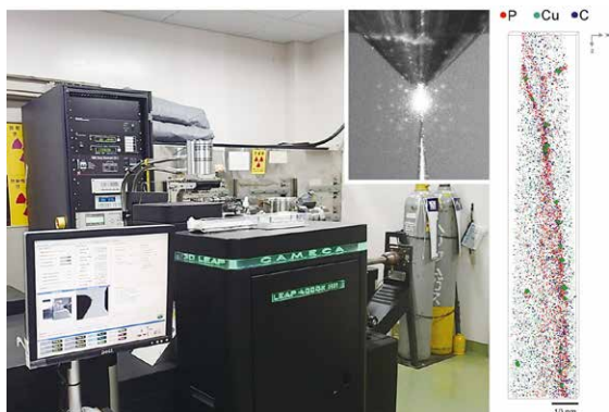
図1: レーザー3次元アトムプローブ装置。原子レベルに近い位置分解能で3次元元素分布を分析することができる。
