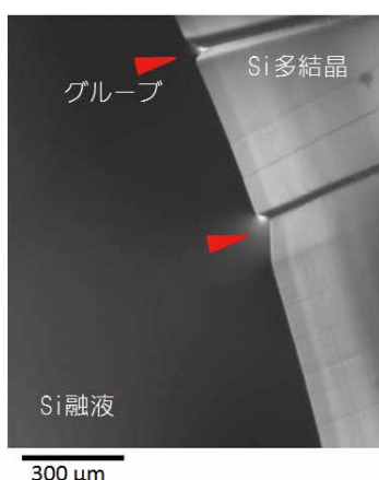
図1: Si多結晶の固液界面に形成される粒界グループの観察。
