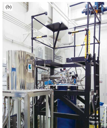
図2: (a)物質の磁化を精密に測定するSQUID磁化測定装置と(b)極低温、強磁場下で金属のフェルミ面などを観測できる希釈冷凍機システム。
