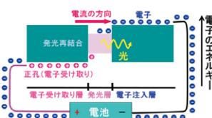
図2: DH構造とLED動作原理
