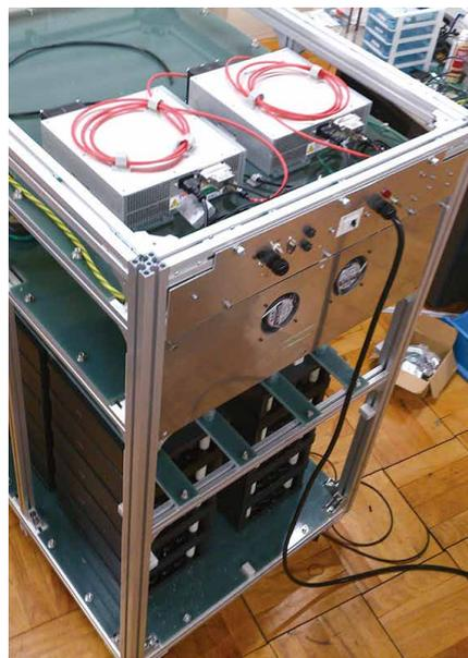
図1: 磁気物理学研究部門で開発した小形ハルズ磁場発生装置。
