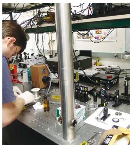
図2: ライス大学での実験風景—光学定盤の上でミニコイルで30テスラを発生して実験を行う。
