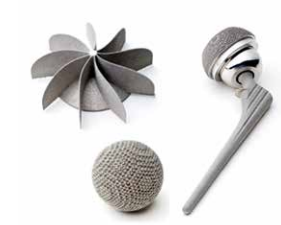
EBMにより作製した三次元金属造形物
