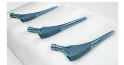
人工股関節インプラント用TiNbSn合金: near β相のため冷間でスウェーピング・溝ロール圧延等の成型加工が可能
