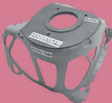
マルチマテリアル金属積層造形による実寸サスペンションタワー(約40cm四方)の試作品
