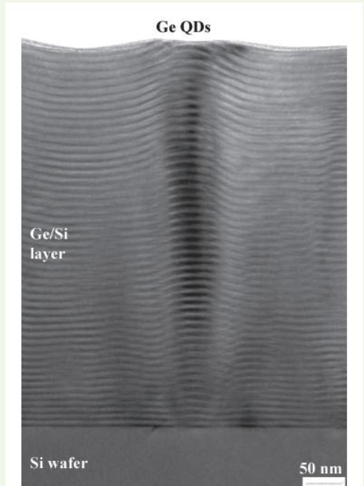
図1: シリコン基板上に成長したゲルマニウム量子ドット積層構造の断面透過型電子顕微鏡写真(先端分析研究部門・木口賢紀准教授による)
