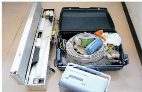
図2 中性子実験用のシステム。左の細長いケースにクライオスタット容器が詰めて持ち運ばれる。受託手荷物サイズに作られ、移動が容易なように設計されている。
