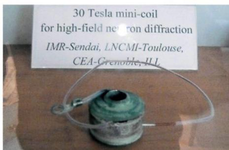
図1 中性子用の持ち運べるパルス磁石。実験の成功を記念してILLの展示コーナーで公開されている
