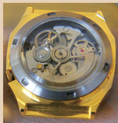
図2: コエリンバーを使用した自動巻腕時計の内部
