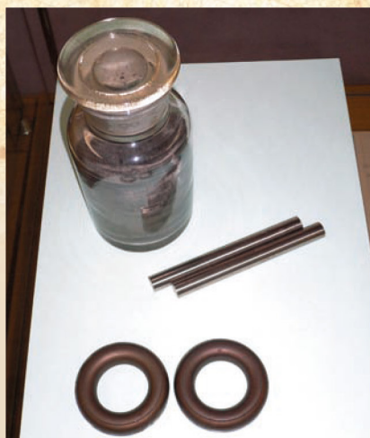
写真2: センダスト粉末（奥）、センダスト棒コア（中間）、通信用部品センダストコア（手前）（金研資料展示室（株）トーキン寄贈）
