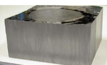
図2: デンドライト利用キャスト法により作製された Si バルク多結晶インゴット。
