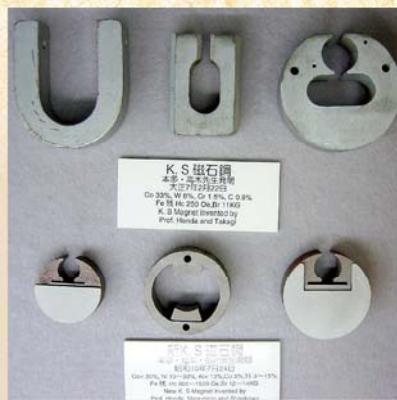
写真3:KS鋼(上段)、新KS鋼(下段)
