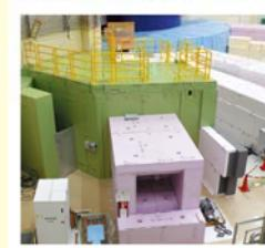
図4:中性子分光器「四季」の建設風景(2008年6月撮影)。高温超伝導の機構解明を第1の目的とした装置で、山田研究室も中心メンバーとして参加している。
