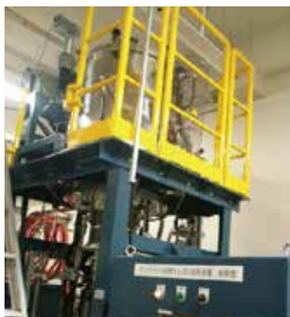
図2: キャスト成長装置と太陽電池用Si多結晶インゴット Figure 2: Casting furnace and multicrystalline Si ingot for solar cells
