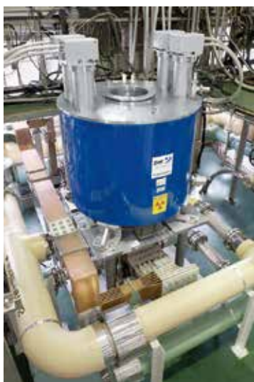
32mmの内径に28Tの強磁場を発生する世界で唯一の無冷媒ハイブリッドマグネット
