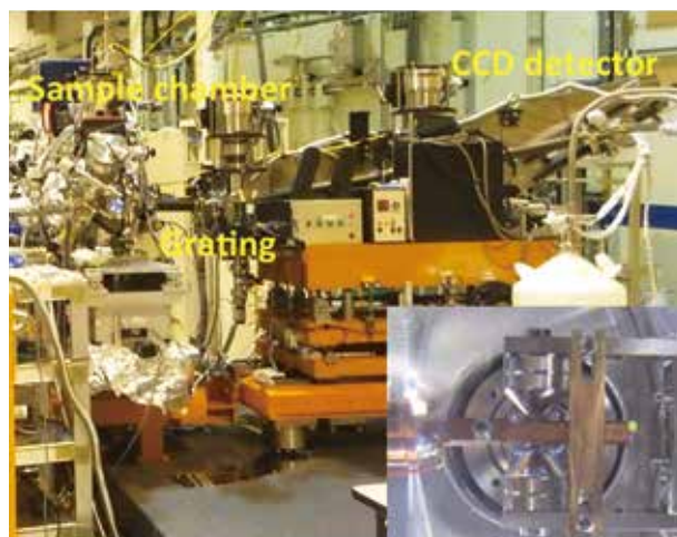
図2:超高分解能X線発光分光器とチャンバー内のミニチュアマグネット
