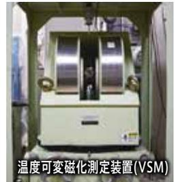
温度可変磁化測定装置(VSM)
