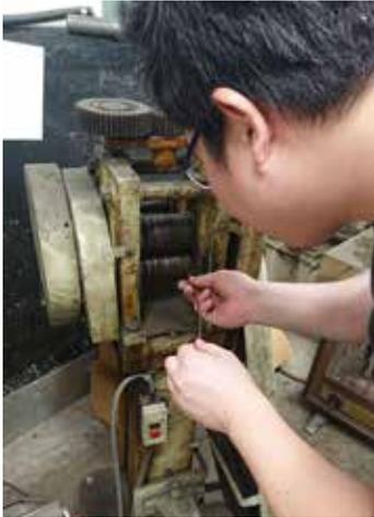
▲溝ロール圧延による金属材料の塑性加工
