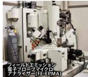
フィールドエミッション電子プローブマイクロアナライザー(FE-EPMA)
