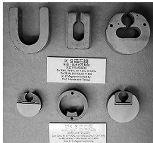
[写真3] KS鋼(上段)、新KS鋼(下段)
