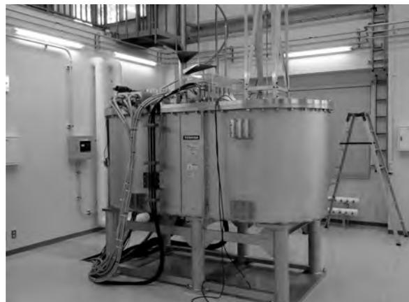
【写真2】実用の超伝導マグネットとして、平成27年11月13日最高磁場まで1時間の磁場掃引モードで、52mm室温実験ボアに世界記録24.6Tの発生に成功した25T無冷媒超伝導マグネット25T-CSM
