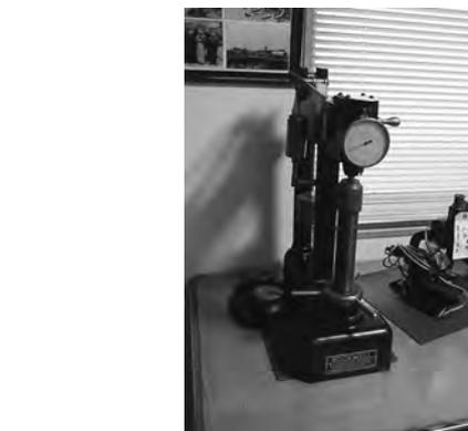
[写真3] ロックウェル硬度計 [所蔵: 東洋金属熱錬工業所]
