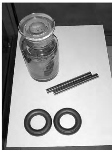
【写真2】 センダスト粉末(奥)、センダスト棒コア(中間)、通信用部品センダストコア(手前)
