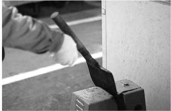
[写真5] 焼き戻しをした製品はどんなに曲げても元に戻る。
