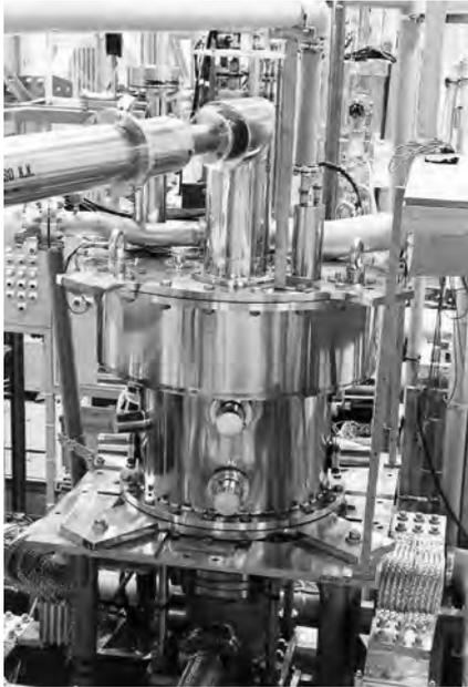
[写真3] 日本初の20Tハイブリッドマグネット HM-3 励磁試験で昭和58年(1983)6月5日32mm 室温実験ポア中心に20.5T達成。
