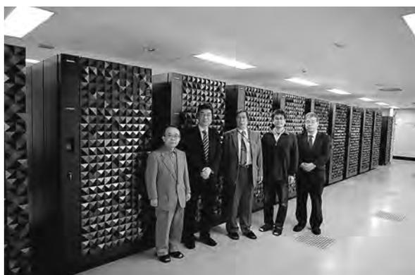
[写真1] 平成24年(2012)4月16日に稼働を開始したばかりの本所の4代目スーパーコンピューターSR16000。10筐体並べるレイアウトは私の主張で、途中で変更したため、日立製作所には、1400本以上もある光ファイバーの束をもう1回作り直してもらうことになってしまいました。
