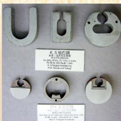
写真3:KS鋼(上段)、新KS鋼(下段)
