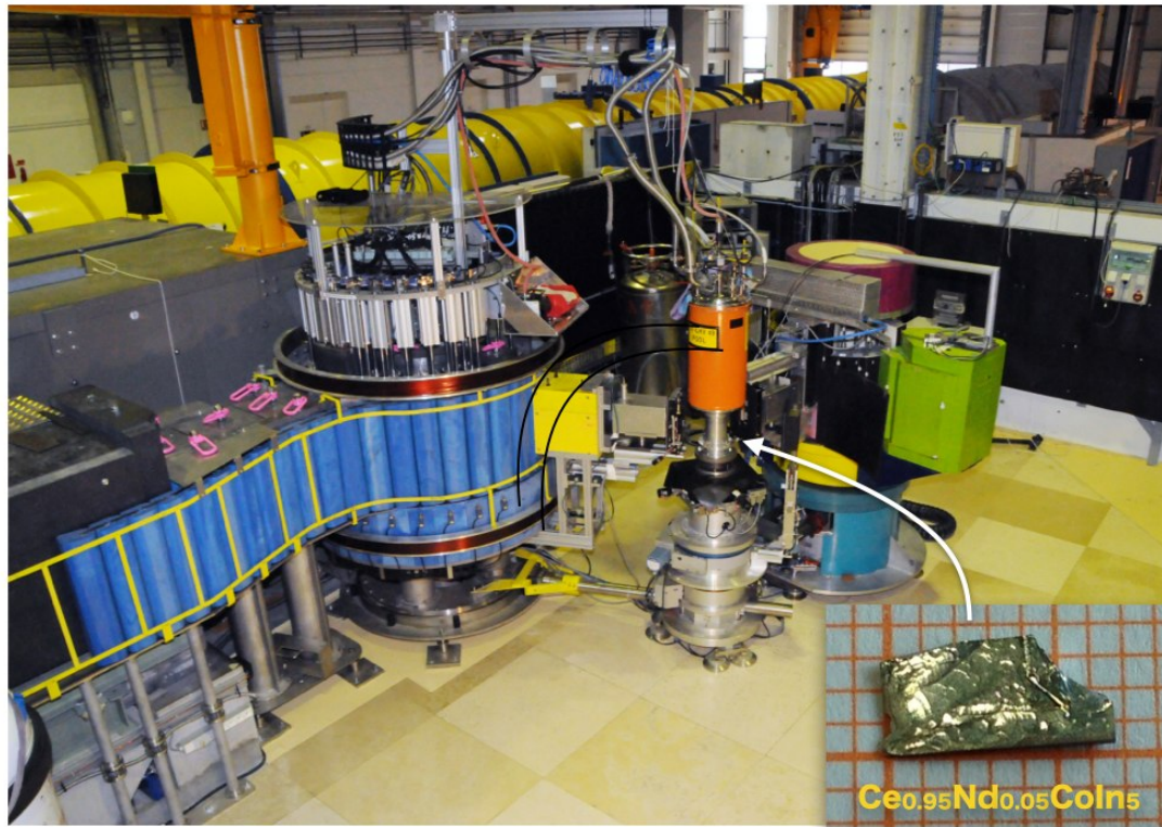
図 2: 実験が行なわれた ILL (ラウエランジュバン研究所) のビームライン IN12 と \text{CeCoIn}_5 に Nd をわずかに置換した単結晶の写真。
